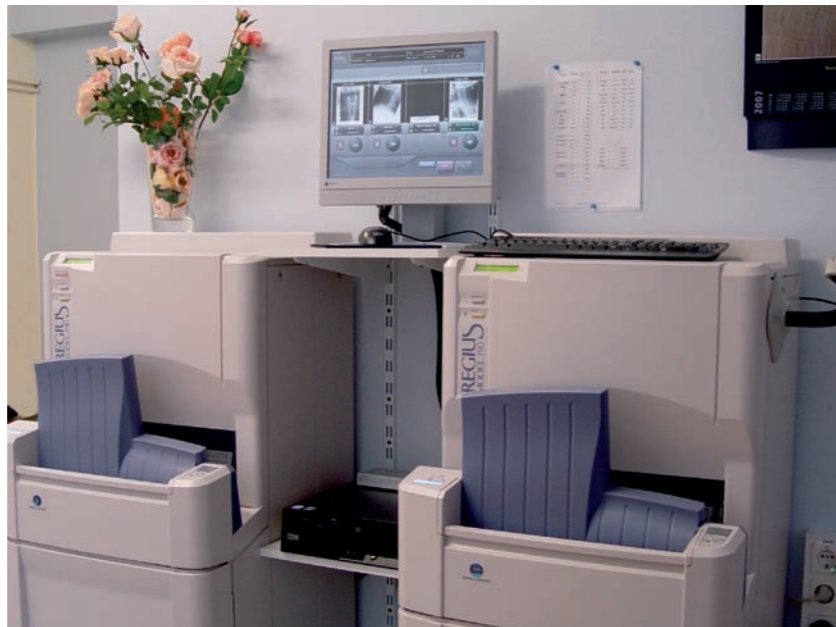
Zwei vernetzte Reader sorgen nicht nur für eine große Leistungsfähigkeit, sie stellen auch im Falle des Defekts eines Systems den Betrieb der Praxis sicher.
